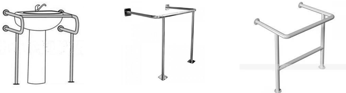
Рисунок 176. НЕ ПРИМЕНЯТЬ! Конструкции поручней со стойками по переднему краю затрудняют доступ на кресле-коляске к раковине/смесителю
