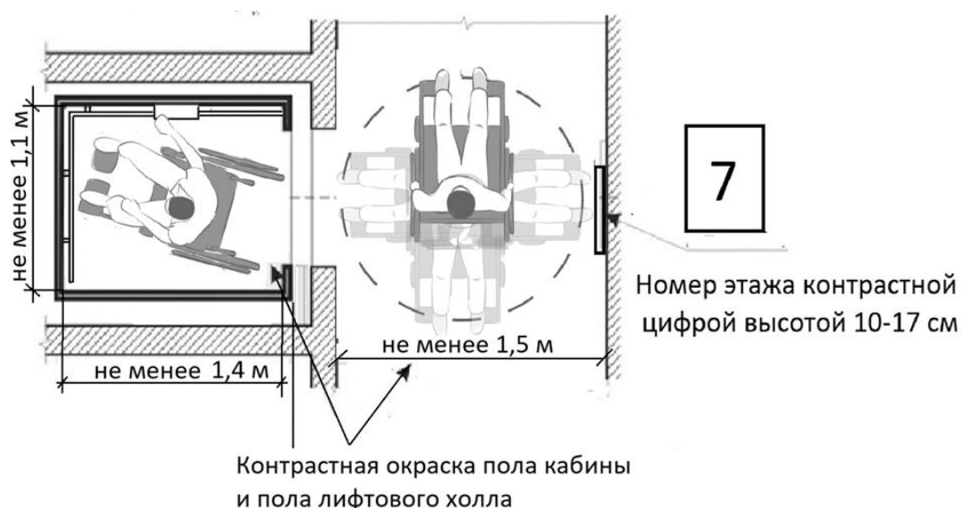
Рисунок 193. Схема лифта, доступного для инвалидов
