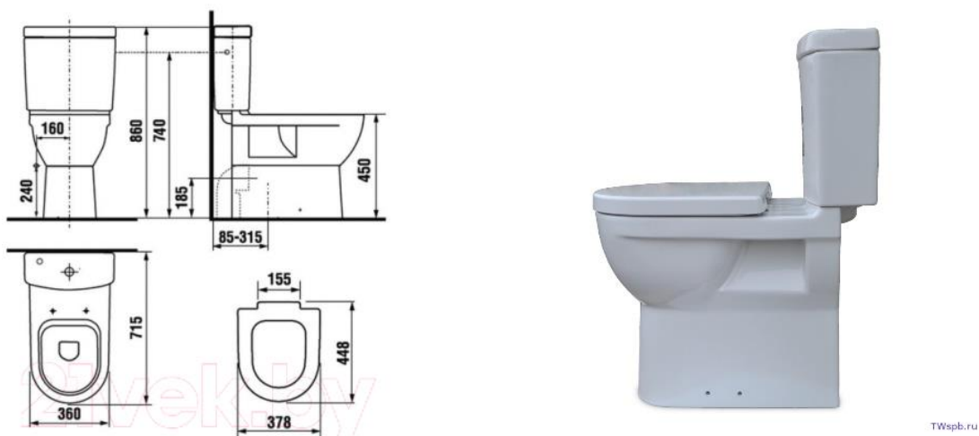
Рисунок 144. Параметры высокого унитаза для инвалидов
