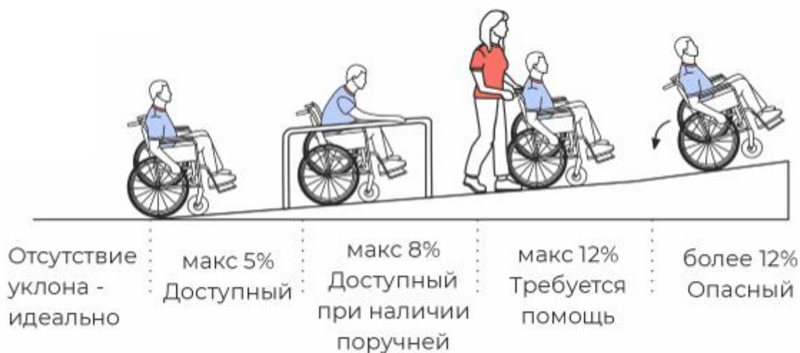
Рисунок 59. Передвижение на кресле-коляске по наклонной поверхности
