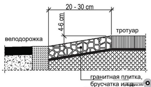
Рисунок 29. Вариант тактильного обозначения края велосипедной дорожки относительно тротуара
