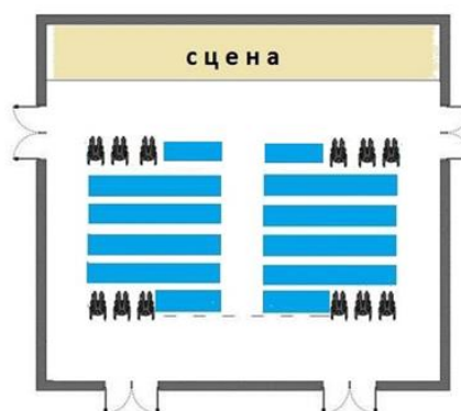
Рисунок 120. Близость мест для инвалидов на кресле-коляске к эвакуационным выходам
