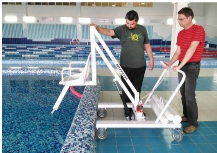
Рисунок 128. Передвижной подъемник для инвалидов в бассейне
