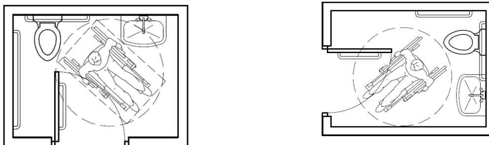
Рисунок 141. Примеры планировок санитарных кабин для инвалидов в затесненных условиях
