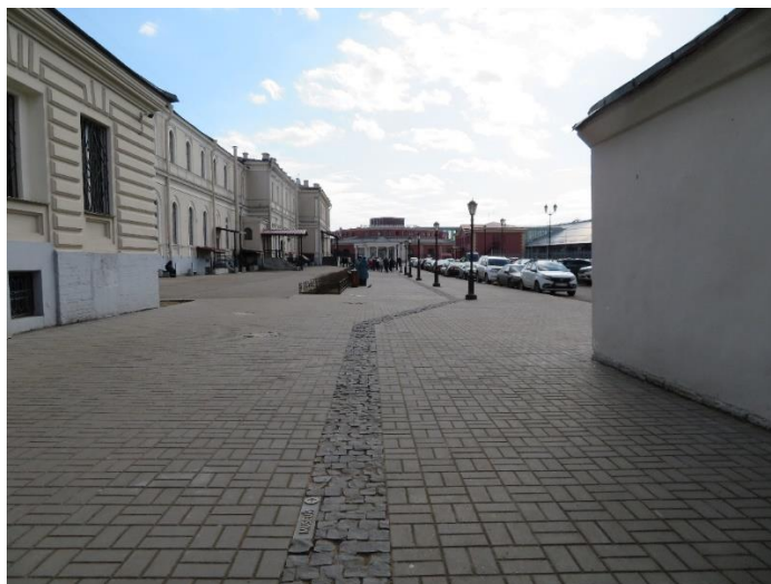
Рисунок 25. Выделение пешеходной части другим типом мощения в зоне с отсутствующим постоянным транспортным движением
