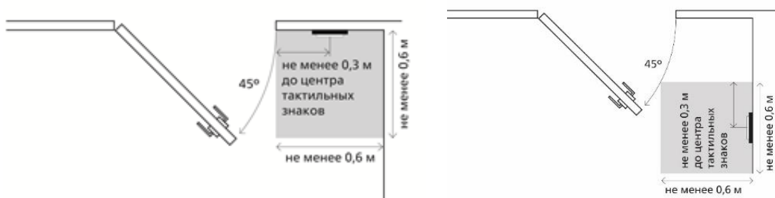
Рисунок 220. Пример проектного решения размещения информационных табличек у дверей
