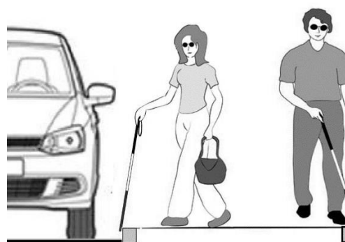
Рисунок 21. Вариант устройства края пешеходных путей. Бортовой камень выполняет функцию указателя направления движения для инвалидов по зрению
