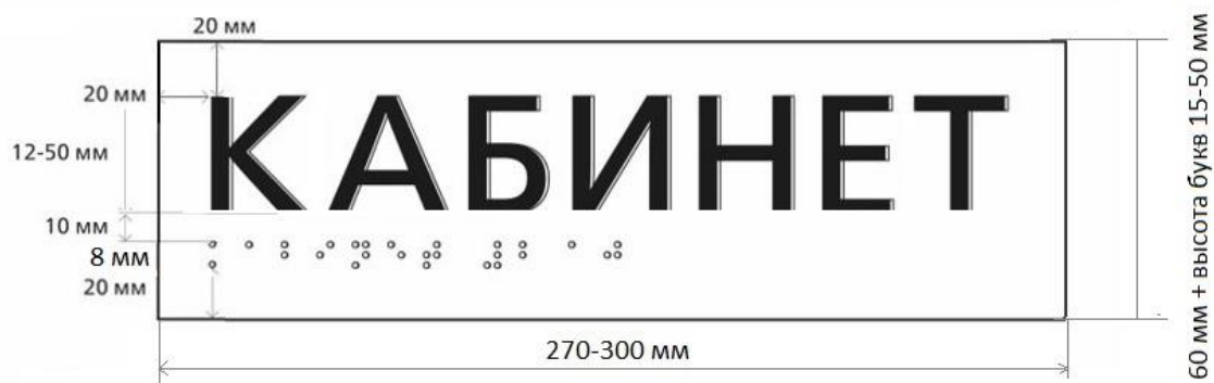
Рисунок 216. Размер таблички с линейно-выпуклым шрифтом и рельефно-точечным шрифтом
